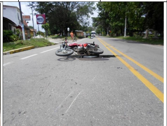
Imagen No 41. Se aprecian de plano medio la correlación de la cantidad y dirección de la huella de arrastre de la motocicleta con respecto a su posición final en la etapa de deslizamiento.
