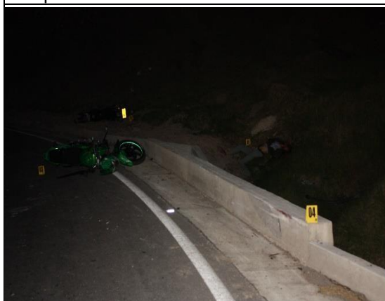
Imagen No 40. Ilustra impacto secundario de motocicleta sobre sardinel en concreto y luego la posición final de esta sobre la vía.
