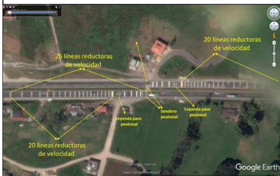
Imagen No 5. Señalización horizontal de marcas viales, conformadas por líneas, flechas, símbolos y letras sobre el pavimento. Cuando en el lugar de los hechos hay un alto volumen de señalización, es importante registrarlas documentando la cantidad, así mismo, la separación entre líneas reductoras de velocidad, a fin de establecerá la diferencia de velocidades a las que el vehículo debe estar circulando por este lugar.
